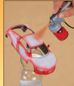
Zuerst eine dünne Farbschicht auf alle Kanten aufbringen. Dann ist ein gleichmäßiger Farbauftrag wichtig: nicht zu dick, sonst verläuft die Farbe – nicht zu dünn, sonst entsteht eine „Orangenhaut“-Oberfläche. Wer mag, kann (wie hier) vorher mit Aqua Color Basic grundieren.
