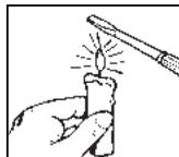
Spitze eines Schraubenziehers erhitzen und auf das herausragende Ende des Plastikstiftes drücken
