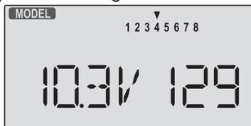
Mit der Taste EDIT up kommen Sie in das Trim-Menü (unterschiedliche Werte, abhängig vom Modell). Wenn Sie die Trimmung für einen Knüppeö betätigen, erscheint der zugehörige Wert. Vergessen Sie nicht anschließen durch einen Trimm-schritt in Gegenrichtung wieder auf den ursprünglichen Wert zu gehen. Wenn Gas hörer **UND** niedriger getrimmt werden soll, stellen Sie den Ausgangswert auf -25%.
