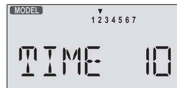
3. Die angezeigte Anzahl der Minuten können Sie mit den Tasten DATA (+) oder (-) ändern. Der Einstellbereich ist 1 bis 60 Minuten.
