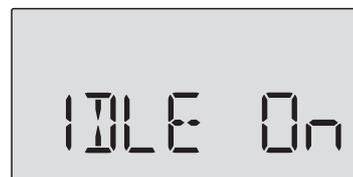
Die Warnung **HOLD On** erscheint im Heli-Betrieb, wenn der Schalter SW 1 (HOLD) aktiviert ist. Wenn Sie HOLD ausschalten und die Warnung IDLE On erschent (siehe oben), müssen Sie Flt.Mode ganz nach vorne schalten. Zur Sicherheit wird kein HF-Signal abgestrahlt, solange diese Meldung sichtbar ist.
