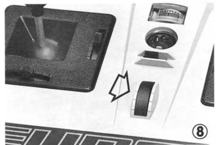
Schneiden Sie vorsichtig mit einem spitzen, scharfen Messer das Klebeschild entlang dem Umfang eines der beiden äußeren Löcher aus; Klebeschild nicht abziehen. In die offene Bohrung nun Schalter einsetzen und mit seiner Rändelmutter festschrauben. Kabel mit Stecker auf Stiftleiste aufstecken.
