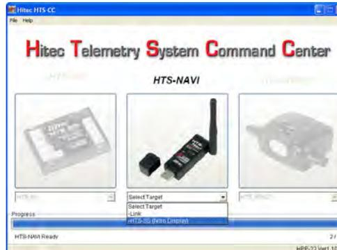
Um die aktuellen Telemetriedaten anzeigen zu bekommen, muss der Sender mit dem Empfänger verbunden und eingeschaltet, sowie die HTS-SS mit dem Empfänger verbunden sein. Wählen Sie „Ja“ im folgend angezeigten Fenster.
