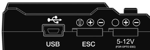
Veuillez connecter le variateur PROcontrol au boîtier de programmation PROcontrol Programmer. Le raccordement s'effectue sur la prise marquée ESC. Utilisez un câble de connexion approprié et veillez à respecter la bonne polarité. Les variateurs ROXXY PROcontrol sont équipés de 2 câbles de connexion. Utilisez le câble à trois brins pour le raccordement au boîtier de programmation.
