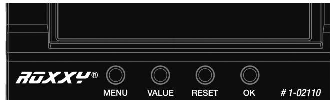
Taste **MENU**: startet die Programmierung und steuert durch das Programmiermenü ( Punkte 1-9 )
