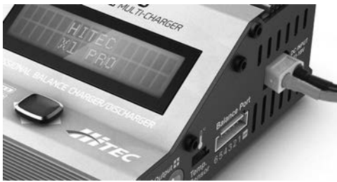
Connecteur XT60 branché directement sur le chargeur.
