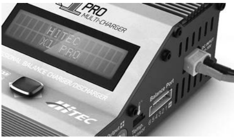
Direkt mit XT60-Stecker am Ladegerät angeschlossen.
