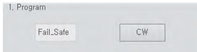
Bei einem Eingangssignal von 900 - 2100µs dreht das Servo standardmäßig im Uhrzeigersinn (CW) von rechts nach links. Sie können die Drehrichtung gegen den Uhrzeigersinn (CCW) ändern, indem Sie wie oben gezeigt auf "CW" klicken.
