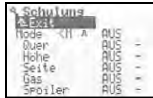
Bild 1: Menü SETUP/Schulung bei Flächenmodellen
