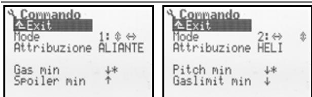
Foto 1: Menu SETUP/Comando con aeromodelli Foto 2: Menù SETUP/Comando con elicotteri
