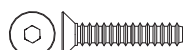
OT242 ④ x6 Flat Head Tapping Screw (M3x16) サラタッピングビス
