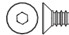
OT242 ⑤ x6 Flat Head Tapping Screw (M3x6) サラタッピングビス
