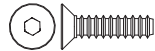
OT242 ⑥ x14 Flat Head Tapping Screw (M3x12) サラタッピングビス
