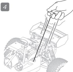
Ziehen Sie am Seilzugstarter, um den Motor zu starten. Er sollte spätestens nach 5 Mal laufen.
