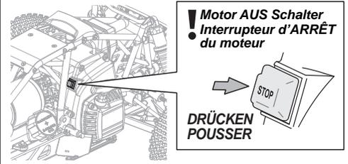
**1** Vorbereitung zum Starten des Motors Préparation au démarrage du moteur
