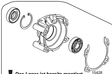
! Das Lager ist bereits montiert.
