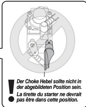
! Der Choke Hebel sollte nicht in der abgebildeten Position sein.
