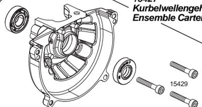
! Das Lager ist bereits montiert.
