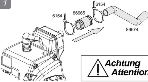
Entfernen Sie den Auspuff (#86674) bevor Sie den Vergaser neu einstellen. Achten Sie darauf, dass der Auspuff kalt ist, bevor Sie ihn anfassen. Ohne Auspuff sind die Reaktionen des Motors deutlicher zu spüren, was es einfacher macht den Vergaser einzustellen. Ohne Auspuff entwickelt der Motor seine maximale Leistung. Wenn er nach dem Einstellen zu laut ist, montieren Sie wieder den Auspuff.
