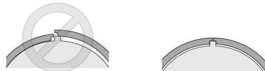
! Montieren Sie den Kolbenring wie gezeigt.
