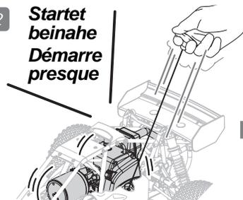
Ziehen Sie (ca. 5 Mal) am Seilzugstarter, bis der Motor beinahe startet. Achten Sie darauf, dass er dabei nicht absäuft.
