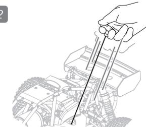
Ziehen Sie am Seilzugstarter, um den Motor zu starten. Er sollte spätestens nach 5 Mal laufen.
