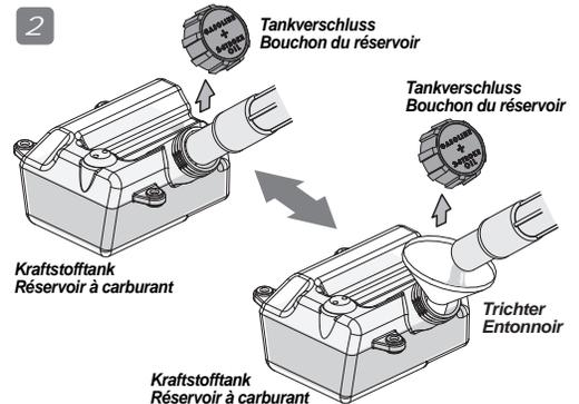
Säubern Sie den Tankverschluss bevor Sie ihn abschrauben. Schmutz und Staub sollten niemals in den Kraftstofftank gelangen. Füllen Sie den Tank mit Gemisch. Achten Sie darauf, dass der Verschluss fest angezogen ist, bevor Sie den Motor starten. Verwenden Sie immer ein Gemisch aus Benzin und Zweitaktöl für diesen Motor. Verwenden Sie niemals Nitro-Kraftstoff.
