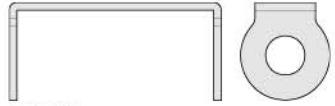
87571 Engine Mount Spacer Motorhalterungs-Spacer Entretien de support moteur エンジンマウントスペーサー
