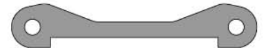
87480 Rear Lower Brace B 6x70x4mm (Orange) Strebe B Hinten, Unten 6x70x4mm (Orange) Renfort arriere inferieur B 6x70x4mm (Orange) リアロアブレース B 6x70x4mm (オレンジ)
