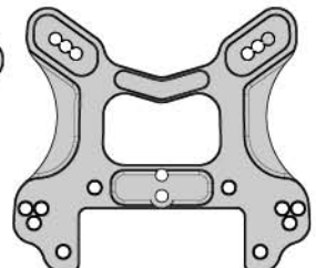
67413 Front Shock Tower DAEMPFERBRUECKE VORNE (D8) Platine d'amortisseur avant フロントショックタワー
