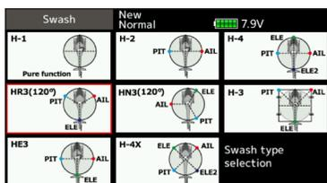
\*Die Modelltyp-Funktion wählt automatisch eine Voreinstellung für die Kanalausgabe, Funktionen und Mischer welche für Helikoptermodelle zutreffen. Es stehen insgesamt 8 Typen für Taumelscheiben zur Auswahl.
