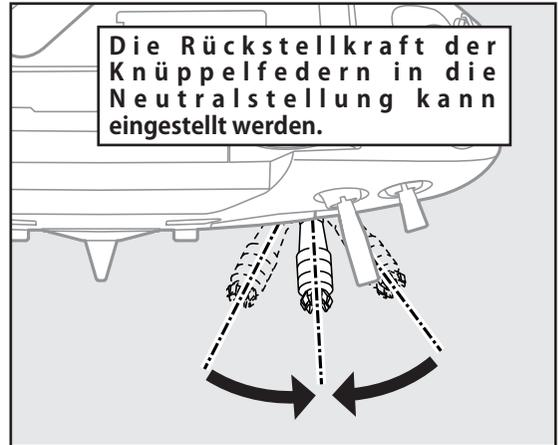
Die Rückstellkraft der Knüppelfedern in die Neutralstellung kann eingestellt werden.
