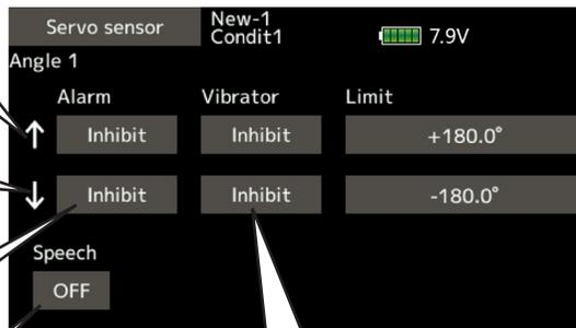
↑ Pfeil nach oben bedeutet: die Alarmauslösung erfolgt, wenn der Servoausschlag über dem eingestellten Wert liegt.
