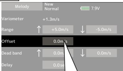
Dies ist der Referenzwert für das Vario, ab welchem ein Steigflug zum Sinkflug wird (und umgekehrt). Die Tonfolge ändert entsprechend von aufwärts zu abwärts (und umgekehrt).
