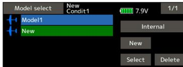
Bis zu 30 Modellspeicher können auf der T16SZ intern abgespeichert werden. Diese Daten können auch auf eine SD-Karte gespeichert werden.
