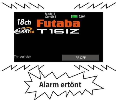
Wenn die Warnung ertönt, muss der Gasknüppel zuerst in die unterste Position gebracht werden.
