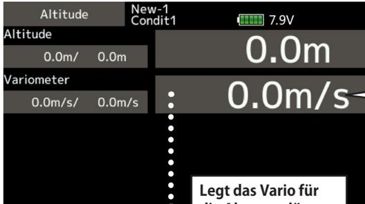
**Maximal / Minimal gemessener Wert wird angezeigt.**
