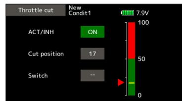
\*bei Gasstellung Leerlauf stellen Sie die Servoposition so ein, dass der Motor ausgeht, aber das Gestänge nicht verhakt.
