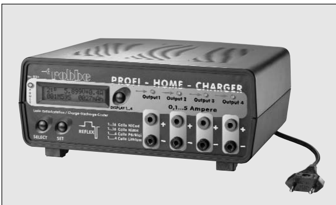
Profi Home Charger No. 8194 Die intelligente und ultimative Heim - Ladestation mit komfor- tablem Akkumanagement, zum Laden und Entladen von NC-, NiMH-, Blei und Lithium-Akkus.
