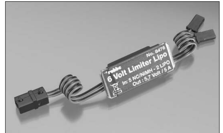
6-VOLT-LIMITER LITHIUM NO. 8476 Stabilisierungsbaustein, macht aus 5-NC-Zellen eine stabile Spannung von 5,7 Volt, maximal 5A Dauerstrom(NC-NiMH), kurzzeitig auch mehr. Dauerstrom Lithium-Akkus ca. 3A.
