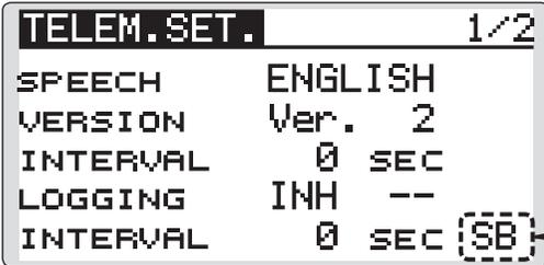
Durch den Pausenschalter ist es nun möglich, eine Telemetrieaufzeichnung zu pausieren, ohne dass der Aufzeichnungsschalter genutzt werden muss.
