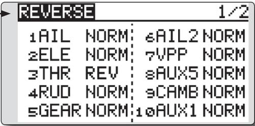
Das Diagramm zeigt einen LCD-Bildschirm mit dem Titel 'REVERSE' und der Seitenzahl '1/2'. Der Bildschirm ist in zwei Spalten unterteilt. Die linke Spalte enthält die Einstellungen für die Servos 1 bis 5, die rechte Spalte für die Servos 6 bis 10. Die Einstellungen sind:
