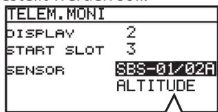
Bei Sensoren mit mehreren Funktionen (z.Bsp SBS-02A) können Sie scrollen, um eine Funktion auszuwählen. (Vario / Höhe / usw).
