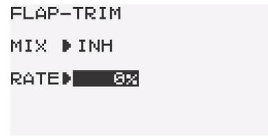
Mit dem Cursor erfolgt die Auswahl innerhalb des FLAP-TRIM Menüs. Mit einer Betätigung der 'End'-Taste gelangen Sie zurück zum Menü.
