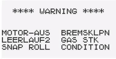
Zeigt an, wenn Mischfunktionen beim Einschalten des Senders aktiv sind. Zusätzlich werden fünf-fach Warntöne ständig wiederholt und die Parameter LED blinkt.
