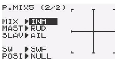
Durch Weiterblättern mit dem Cursor wird das 2. Display eines Kurvenmischers angezeigt. Dort lassen sich wie zuvor beschrieben die notwendigen Einstellungen, wie z.B. Master- und Slavekanal, aber auch die Auswahl eines Aktivierungsschalter durch-
