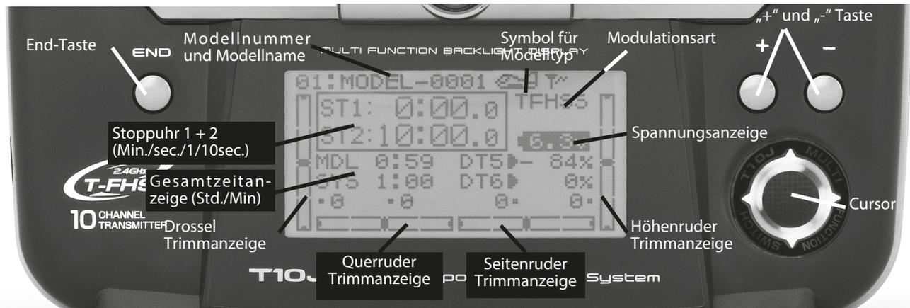
Während der Sender eingeschaltet wird, ertönt zur Bestätigung kurz der eingebaute Piezosummer und das Display erscheint in der oben stehenden Darstellung.
