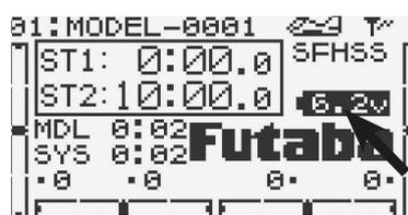
Die aktuelle Akkuspannung des Senders wird über das große LC-Display in Volt angezeigt.
