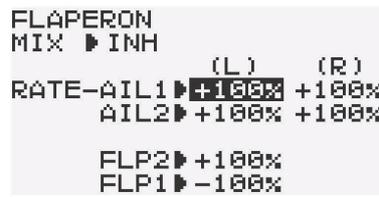
Mit dem Cursor erfolgt die Auswahl innerhalb des Flaperon-Mischer Menüs. Mit der 'End'-Taste gelangen Sie zurück zum Menü.
