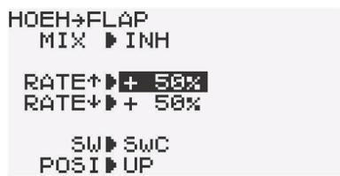
Mit der „+“ bzw. „-“ Taste wird die Funktion unter „MIX“ aktiviert. Im Display wird 'ON' oder 'OFF' angezeigt.
