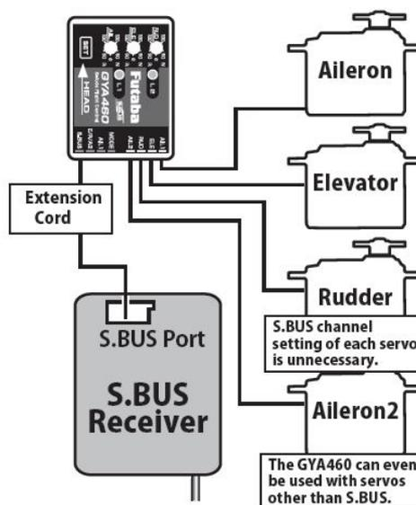
GYA460 Anschluss SBUS ->an Empfänger SBUS
