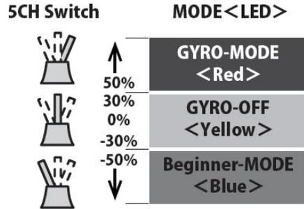
Alternativ können auch zwei 2-fach Schalter verwendet werden. Wählen Sie die Einstellungen für den 2.Schalter entsprechend dem Bild.
