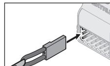
Installare il connettore di binding
