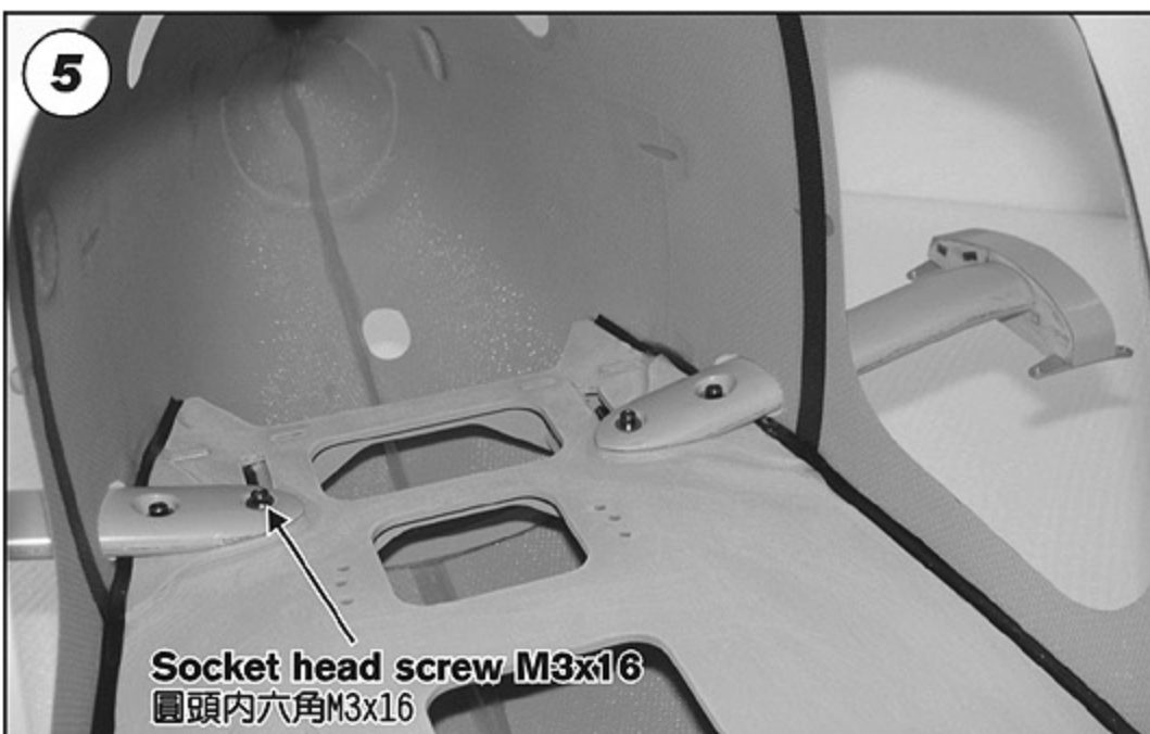
5 Mount the launching supports with socket screws T3x16 and washers \Phi 3.4 \times \Phi 8 \times \Phi 8 \text{mm} . 以圓頭內六角螺絲T3x16與華司 \Phi 3.4 \times \Phi 8 \times \Phi 8 \text{mm} 分別將左、右發射器支撐架鎖附在機身固定架上。
