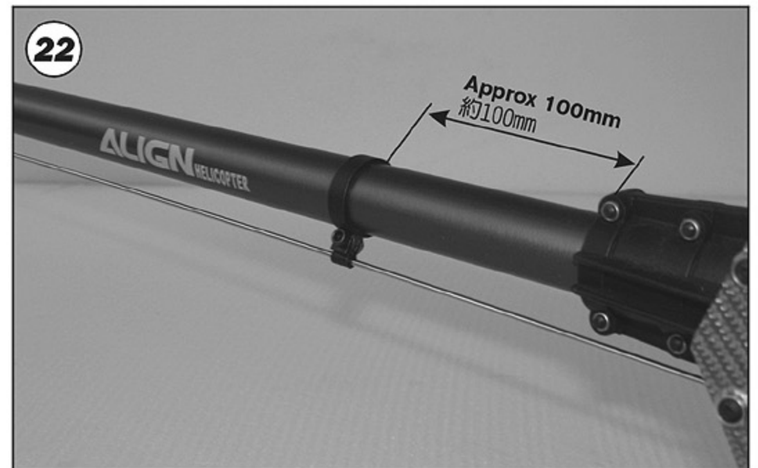
22 Assemble the attached shorter rudder control guide. 裝上隨附較短的尾控制桿固定環。
