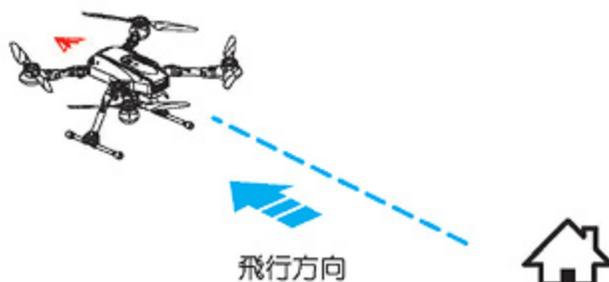
自動返航功能是輔助無人機在操控過程中，若發生迷航或距離太遠無法辨識正確飛行方向時，可藉由飛控系統執行自動返航指令，讓無人機在安全機制下自動駕駛安全返回Home點。
