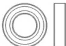
Bearing 軸承(φ10xφ19x5mm) x 2
