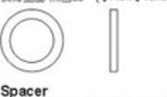
Spacer 橫軸墊圈(φ8xφ11.5x1.3mm) x2
