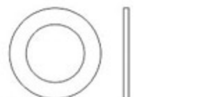
Washer 單向軸承墊圈(φ11.5xφ18x0.8mm) x1
