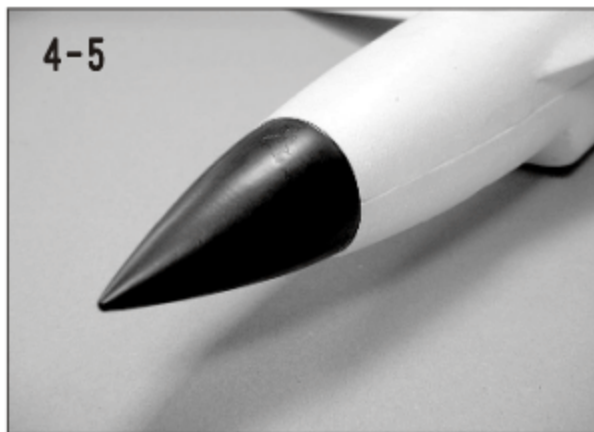
4-5 同樣的將機頭罩以AB膠固定(PS.機頭罩的錐心須偏下方)。
