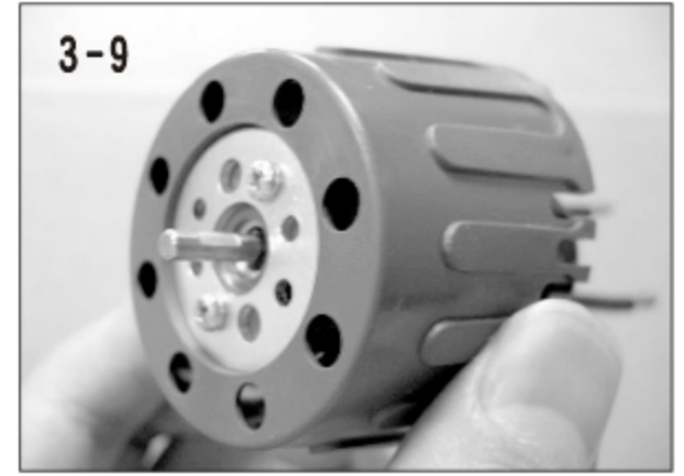
3-9 將馬達、噴射座及固定片依上圖方式組裝完成。
