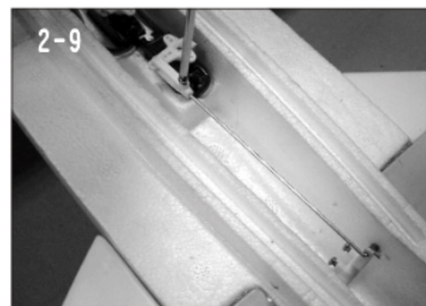
2-9 將控制桿一端勾入T型接頭後，於伺服器兩側塗上AB膠並壓入伺服器座，此時將伺服器暫時接上電源歸中立點，調整連桿長度至水平翼水平，再將連桿夾片以M2X4螺絲固定。
