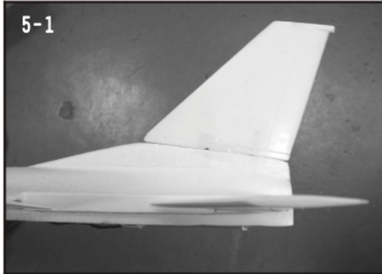
當以AB膠固定水平翼連桿與左、右水平翼時，注意左、右水平翼皆須水平。
