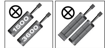
No combine baterías de diferentes capacidades. Utilice dos baterías con la misma capacidad.
