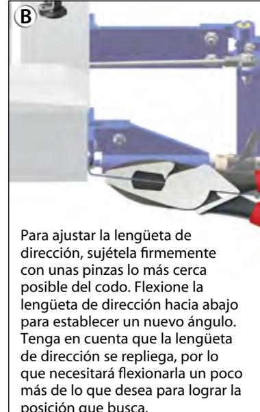
Para ajustar la lengüeta de dirección, sujétela firmemente con unas pinzas lo más cerca posible del codo. Flexione la lengüeta de dirección hacia abajo para establecer un nuevo ángulo. Tenga en cuenta que la lengüeta de dirección se repliega, por lo que necesitará flexionarla un poco más de lo que desea para lograr la posición que busca.
