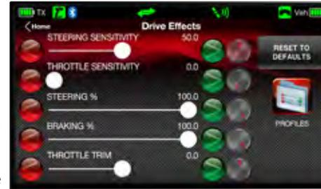
Golpee y deslice para ajustar la sensibilidad de la dirección, el nivel del acelerador, el porcentaje de frenado, ¡y más!
