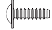
SCB004 e SCB005 d x7 SC247 e Flange BH M3x10mm フランジボタンTPビス
